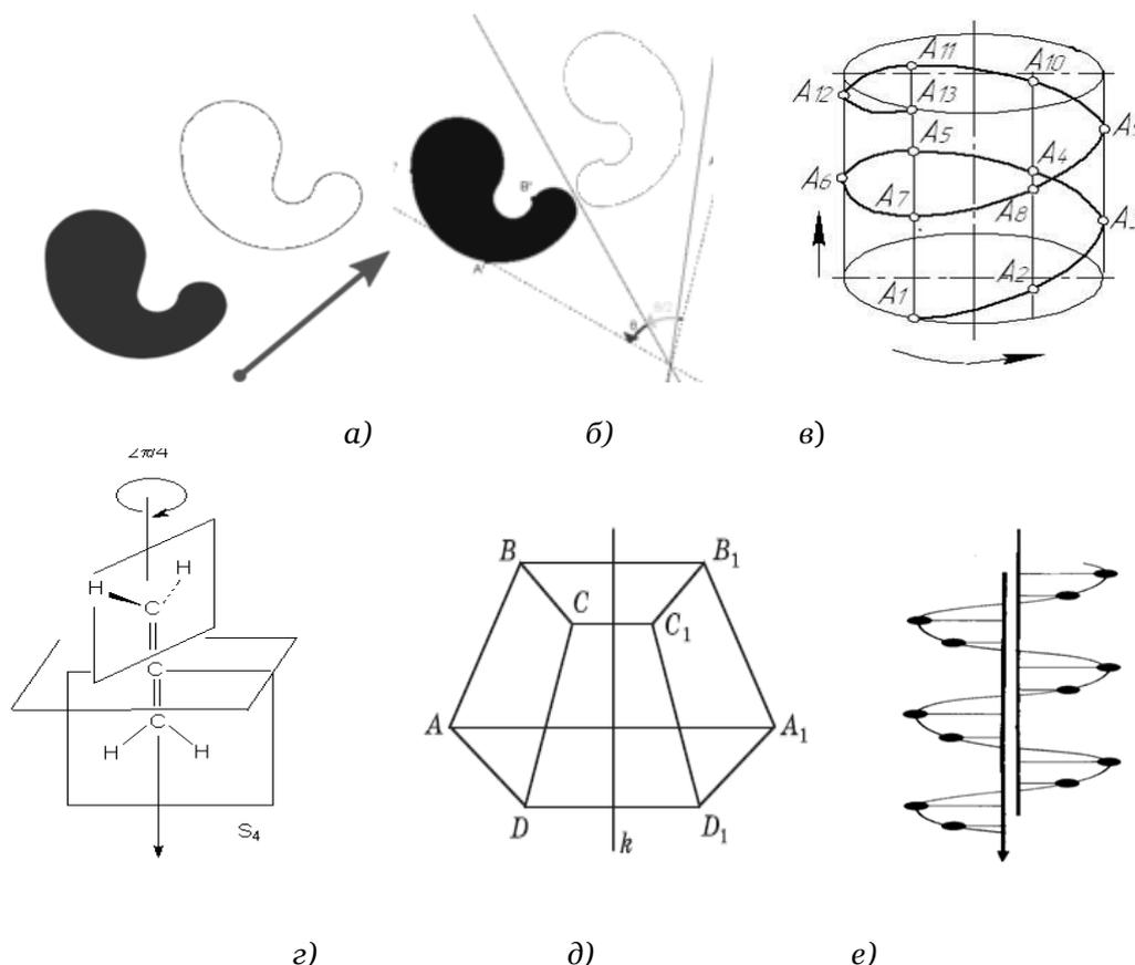
**Рис. 3.** Движение трехмерного пространства: а – параллельный перенос; б – осевая симметрия; в – винтовое движение; г – отражение от плоскости; д – поворотное отражение (зеркальная симметрия); е – скользящее отражение
