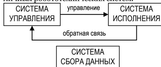
Рис. 1. Кибернетическая модель робота
