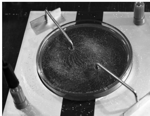
Рис. 4. Электростатическое поле двух точечных зарядов
