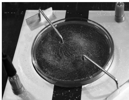
Рис. 4. Электростатическое поле двух точечных зарядов
